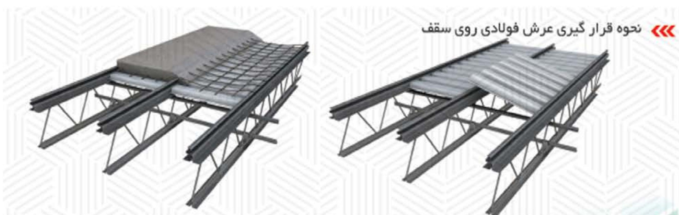
سقف عرشه فولادی با ورق‌های گالوانیزه ذوزنقه‌ای شکل آجدار بدون استفاده از میلگرد و قالب‌بندی اجرا می‌شود. وزن سقف عرشه فولادی حدود ۳۰ تا ۶۰ درصد کمتر و سرعت اجرای آن حدود ۱۲ برابر بیشتر از سقف‌های دال بتنی و تیرچه بلوک می‌باشد.
